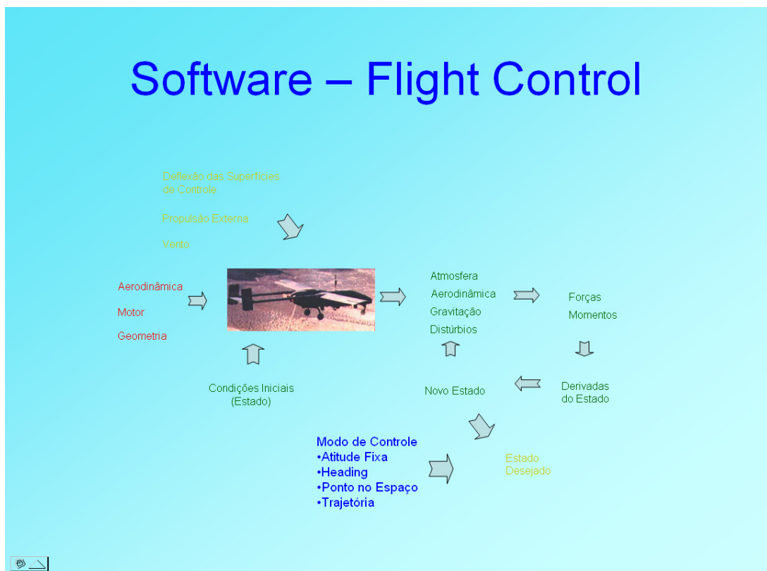
Figura 1 – Esquema do algoritmo de controle de voo
